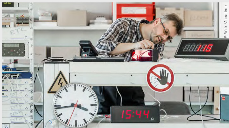
Im Labor prüfen Bürk-Ingenieure das Zusammenspiel der Komponenten, bevor ein Zeitdienstsystem ausgeliefert wird
