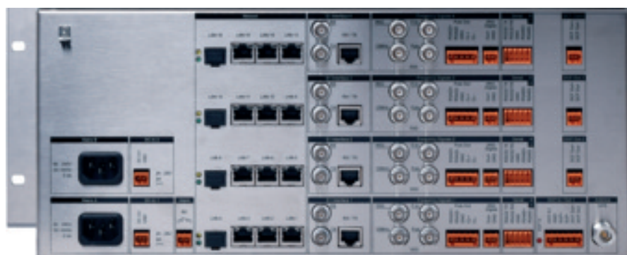
Moderne Zeitserver stellen eine hochpräzise Zeit- und Frequenzsynchronisation in den Verkehrsleitstellen sicher. Die DTS 4210-Zeitzentrale von Bürk Mobatime stellt sogar bis zu 16 LAN-Schnittstellen (IPv4/IPv6) bereit.
