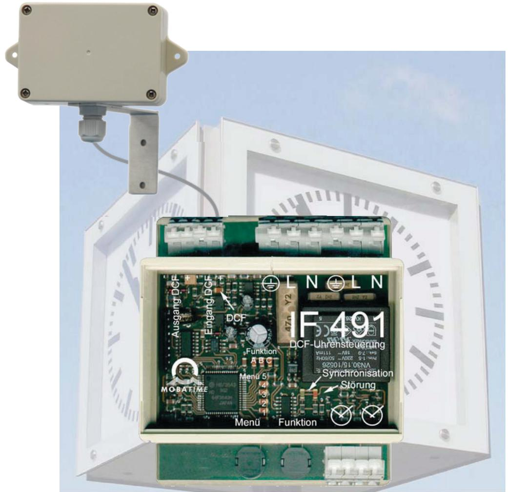
Diese DCF 77-Uhrensteuerung ermöglicht die Funkführung von bis zu 4 analogen Impuls-Nebenuhrwerken und macht so aus Nebenuhren Funkuhren mit vollautomatischer Sommer-/Winterzeitumstellung
