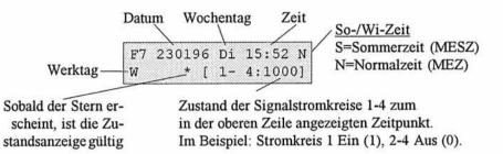
Mit jeder Betätigung der 🗲 Taste wird die Uhrzeit eine Minute vorgestellt. Es kann jedes Datum und jede Zeit eingegeben und der Zustand der Signalstromkreise zu diesem Zeitpunkt überprüft werden. Bsp.: 1. Nov 96, 16:00.
